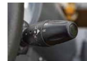
**Многофункциональный переключатель** позволяет легко управлять светом и звуковым сигналом.
